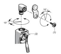
(1) Tightening torque (Min : 1) (Max : 1.5)
