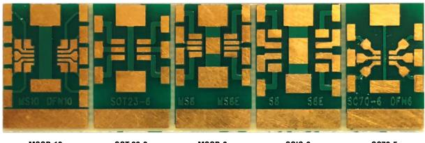
MSOP-10 3x3 DFN-10 SOT-23-3 SOT-23-5 SOT-23-6 MSOP-8 MSOP-8E 3x3 DFN-8 SOT-23-8
