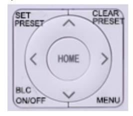
Up: press Down: press Left: press Right: press Back to middle position: press (HOME)
