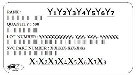
Table 5. Part Numbering System: X<sub>1</sub>X<sub>2</sub>X<sub>3</sub>X<sub>4</sub>X<sub>5</sub>X<sub>6</sub>X<sub>7</sub>X<sub>8</sub>
