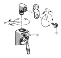
(1) Tightening torque (Min : 1) (Max : 1.5)(2) Tightening torque (Min : 0.8) (Max : 1.2)
