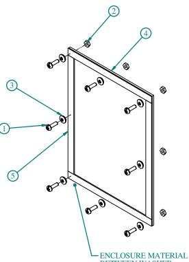
ENCLOSURE MATERIAL BETWEEN WASHER AND GASKET.
