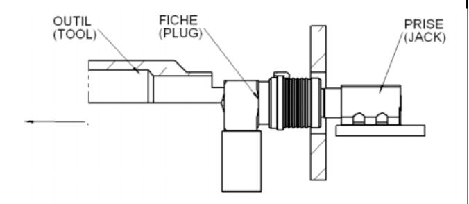
Tirer sur l'outil pour désaccoupler les connecteurs. (Pull the tool off to disconnect the connectors)
